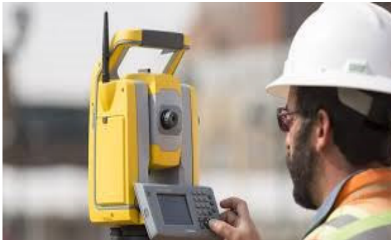
Figura 2.2.2-35 Localización y replanteo
