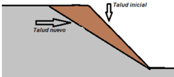
Disminución de la inclinación del Talud (Perfilado)
