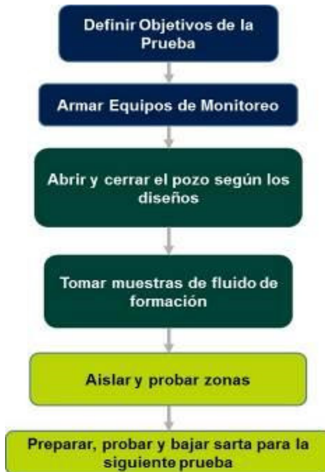
Figura 2.2.2-100 Esquema de las pruebas de producción a realizar en los pozos perforados
