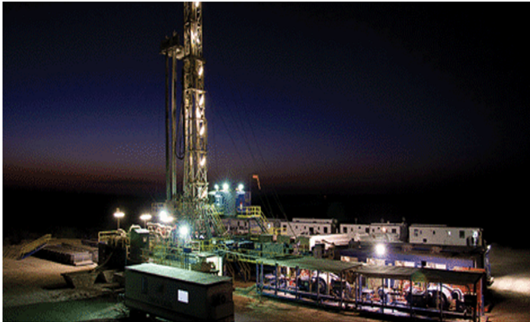
Figura 2.2.2-102 Equipo de Workover para reacondicionamiento de pozos
