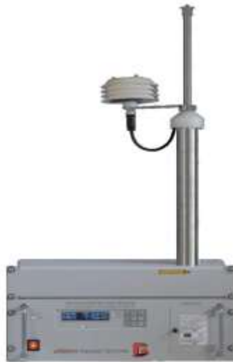
Figura 3.2.9.2-21 Equipo toma de muestra PM 2.5
