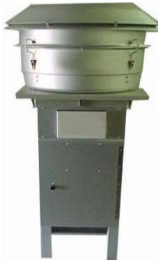
Figura 3.2.9.2-20 Equipo HI-Vol para monitoreo PM10
