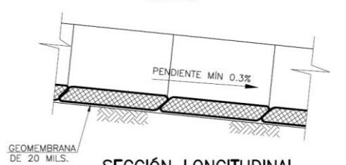
CUNETA TRAPEZOIDAL EN SACOS DE SUELO-CEMENTO ESCALA 1:20
