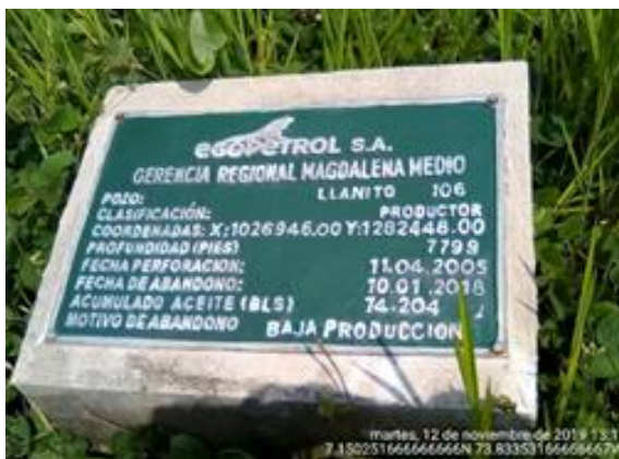
Figura 10-14 Ejemplos de Placa de abandono para pozos
