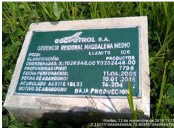
Placa de abandono de un pozo
