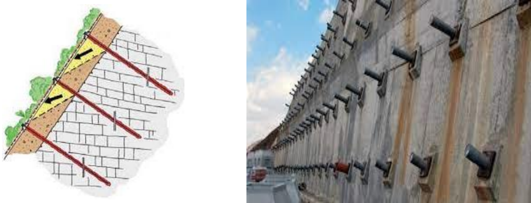
Diferente disposición de anclajes en un talud
