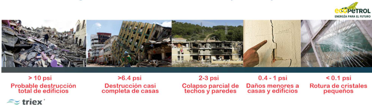
Figura 32 Niveles de afectación por sobrepresión
